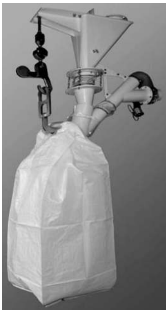
Рис. 6. Комплекс фасовки цемента «АТЛАНТ»
