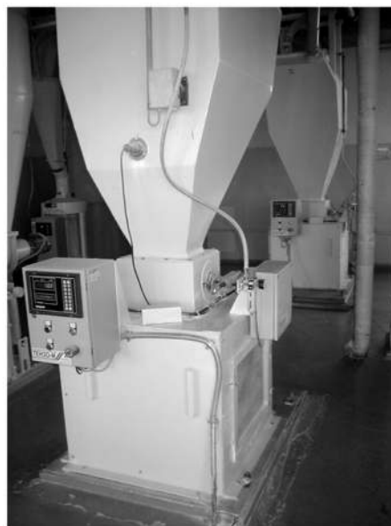
Рис. 2. Бункерные весы «Поток» серии АВБ на мельнице Раменского КХП, июнь 2002 года
