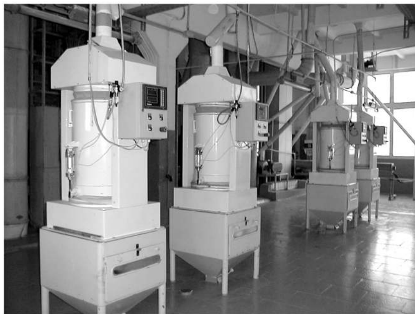
Рис. 1. Весы с бункером цилиндрической формы
